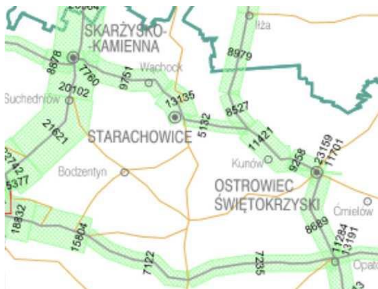
Wyciąg z mapy analizy „Średniego Dobowego Ruchu Pojazdów Silnikowych na sieci dróg krajowych w roku 2015”, opracowanego dla GDDKiA
